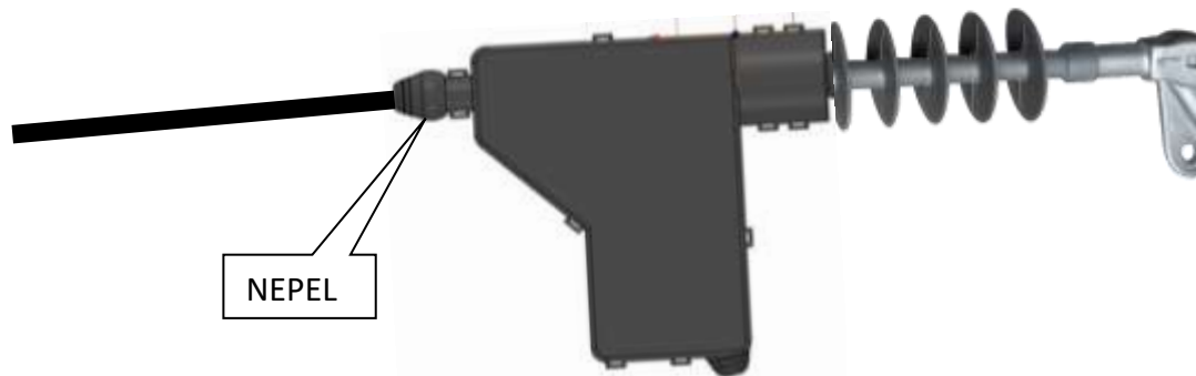
GAMBAR 1. PEMASANGAN UNTUK COVER STRAINCLAMP/ KLEM PISTOL PADA ISOLATOR TARIK DI TIANG AKHIR
